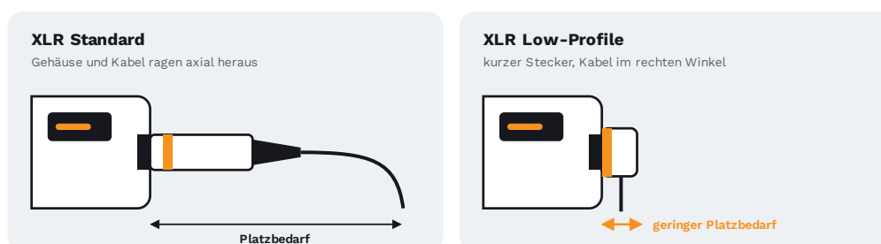
Fig. 2.2 Die zwei XLR-Varianten, die bei der Bestellung wählbar sind. Low-Profile ragt deutlich weniger aus dem Rekorder: praktisch in einer kleinen Tasche. Prinzipskizze.
