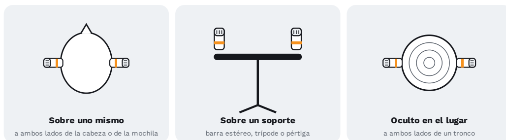
Fig. 5.4 Tres colocaciones habituales de un par omni (Standard V2, Nano 2, Professional).
